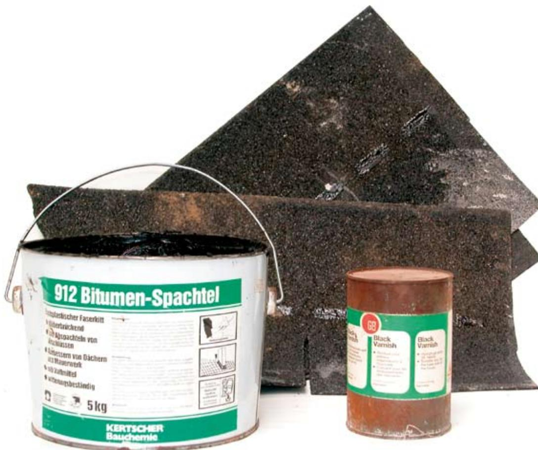
Le bitume et les produits goudronnés sont des substances découlant du raffinage du pétrole et, il y a quelques années encore, du traitement du goudron huile.
